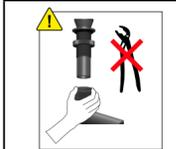
**Ziehen Sie die Verbindungen der Anschlussrohre nur handfest an! Verwenden Sie keine Zangen oder andere Werkzeuge mit hoher Kraftübertragung!**
